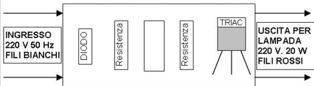
**SV-ELA** Elettronica lampeggiante a mezzo Triac. Intermittenza elettronica, lampada incandescenza. Ripetitore di allarme remoto, oppure su cancelli automatici, cicli di lavorazione. Alimentazione 220 V 50 Hz. Supporta lampade potenza fino a 20 W. Protetta da involucro al silicone. Collegamento con 4 fili. Dimensioni H24XL26XS16 mm. Peso 0,03 gr.
